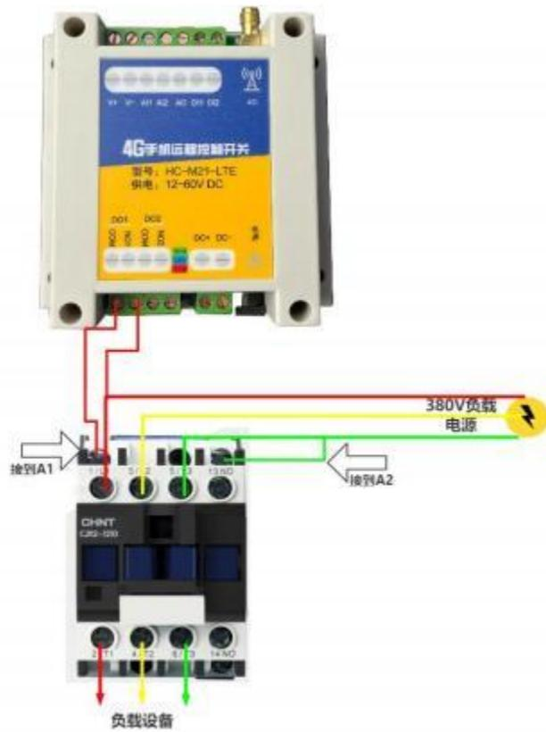
下图为用第一二路通道控制三制电机正反转，第一路打开是正转，第二路打开是反转，同时打开或者关闭电机不转：
