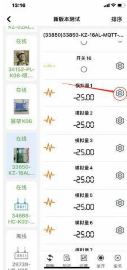
**报警参数的填写：**如图中所示设置报警上限为 2.3，报警下限为 2.0，若设置报警模式为上限报警，则会实现这样的功能：当液位高于 2.3 米的时候报警，一直到低于 2.0 米的时候解除报警；
