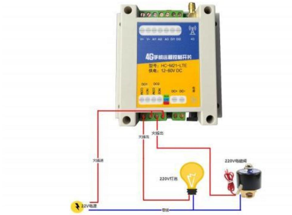
下图为用第一路通道控制 220V 线圈的交流接触器并带 220V 负载：
